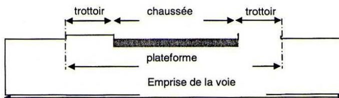
**Plate forme des voies** : La surface destinée à recevoir les équipements nécessaires à l'utilisation de la voie.
